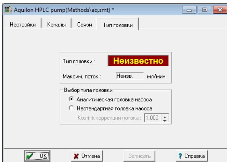
При установке переключателя **Аналитическая головка насоса** в поле **Тип** указывается объем головки – 5 или 10 мл, определяемый автоматически. Также автоматически указывается значение в поле **Максим. поток**.
